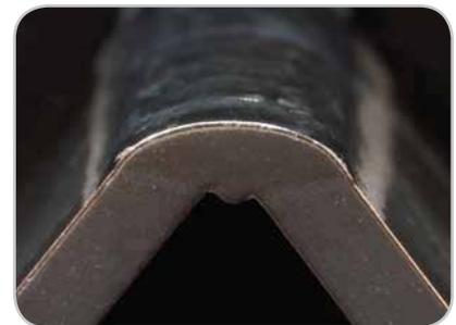
Un arco estable garantiza una soldadura homogénea y una fuerte adherencia al material base, asegurando las buenas propiedades mecánicas de la unión.
