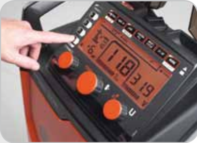
Los modelos Kempact Adaptive (A) incorporan características especiales, como controles para la configuración de potencia según el ancho de la placa, selección de los materiales de relleno y canales de memoria.
