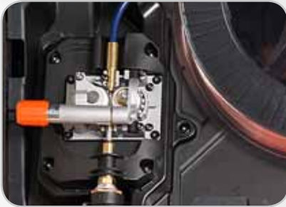
Los modelos Kempact 181/251 incluyen la unidad de alimentación de alambre GT02, con dos rodillos.
