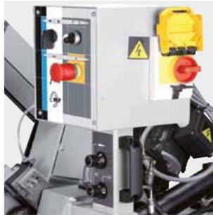
Las PH 211-1, sierras manuales de cinta para cortes de 0° a 60° hacia la izquierda también se suministran en la versión con dispositivo HB que permite realizar cortes únicos sin operador, manteniendo igualmente el ciclo de corte manual (el dispositivo HB sólo está disponible en las versiones trifásicas). CICLO DE CORTE HB:
